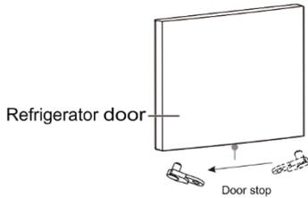
16. Instale la puerta del compartimiento del refrigerador.
