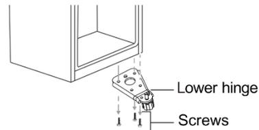
7. Retire la arandela y la tuerca que sujetan el eje del pasador al orificio derecho de la bisagra inferior y luego retire el eje.
