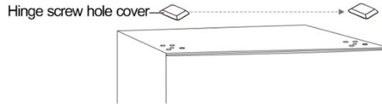
19. Asegure la bisagra superior al lado superior izquierdo del gabinete con los tres tornillos que quitó anteriormente. Antes de apretar los tornillos de la bisagra superior, asegúrese de que la parte superior de la puerta esté nivelada con el gabinete y que la junta de goma haga un buen sello.
