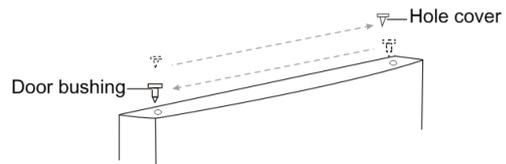
18. Retire la cubierta del orificio del lado superior izquierdo del gabinete y asegure la cubierta en el lado superior derecho del gabinete.
