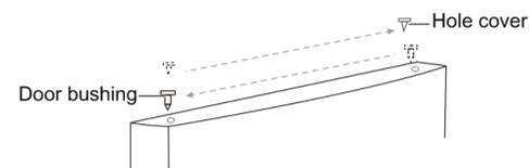
13. Retire el tapón del orificio para tornillos de la bisagra central en el lado izquierdo del gabinete, luego instálelo en los orificios para tornillos en el lado derecho del gabinete.
